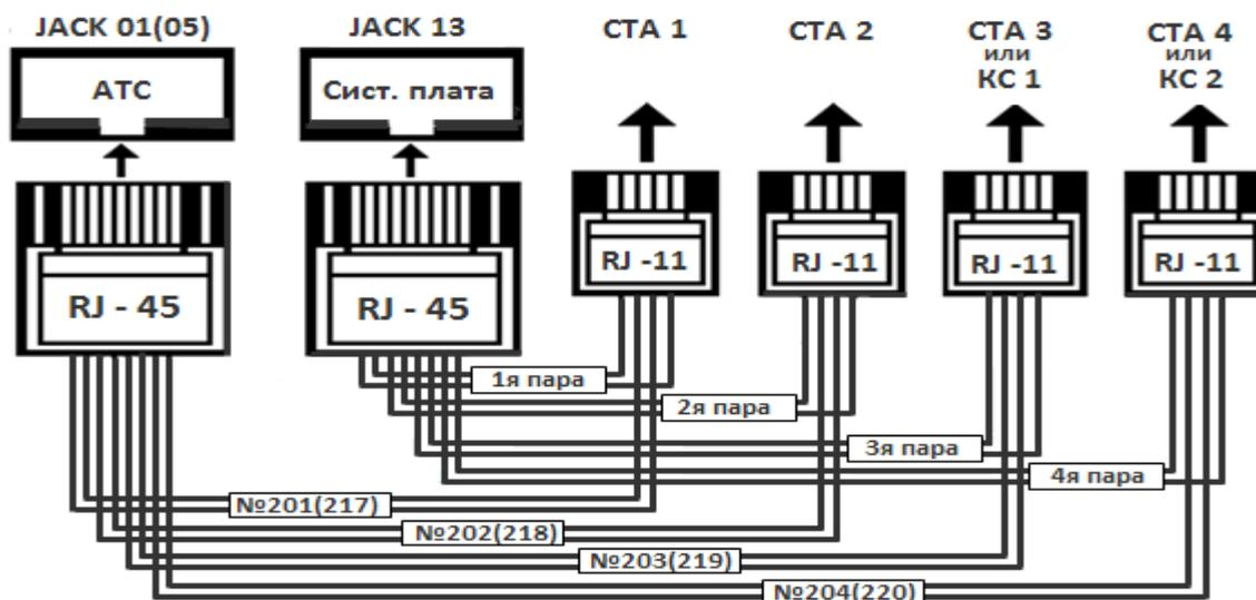
**ЖАКК 01** - разъём RJ-45 на плате №1 АТС, с аппаратными номерами **201-204** ( №201-1ая пара , №202- 2ая , №203- 3я , №204- 4ая )
